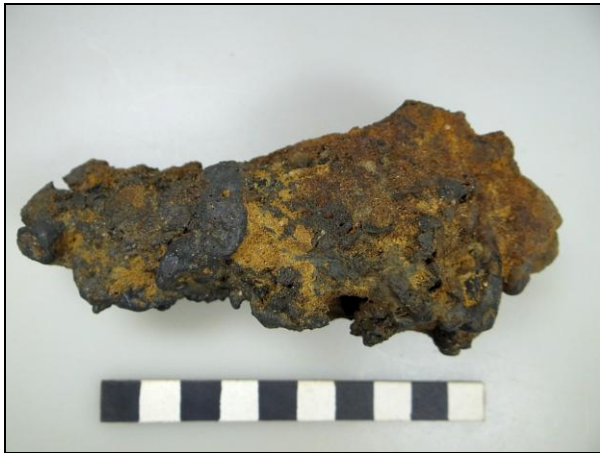
Afbeelding 41. Zijaanzicht van productieslak (Vondst nr. 42). De bovenzijde is partieel magnetisch. De schaalverdeling is in cm.
