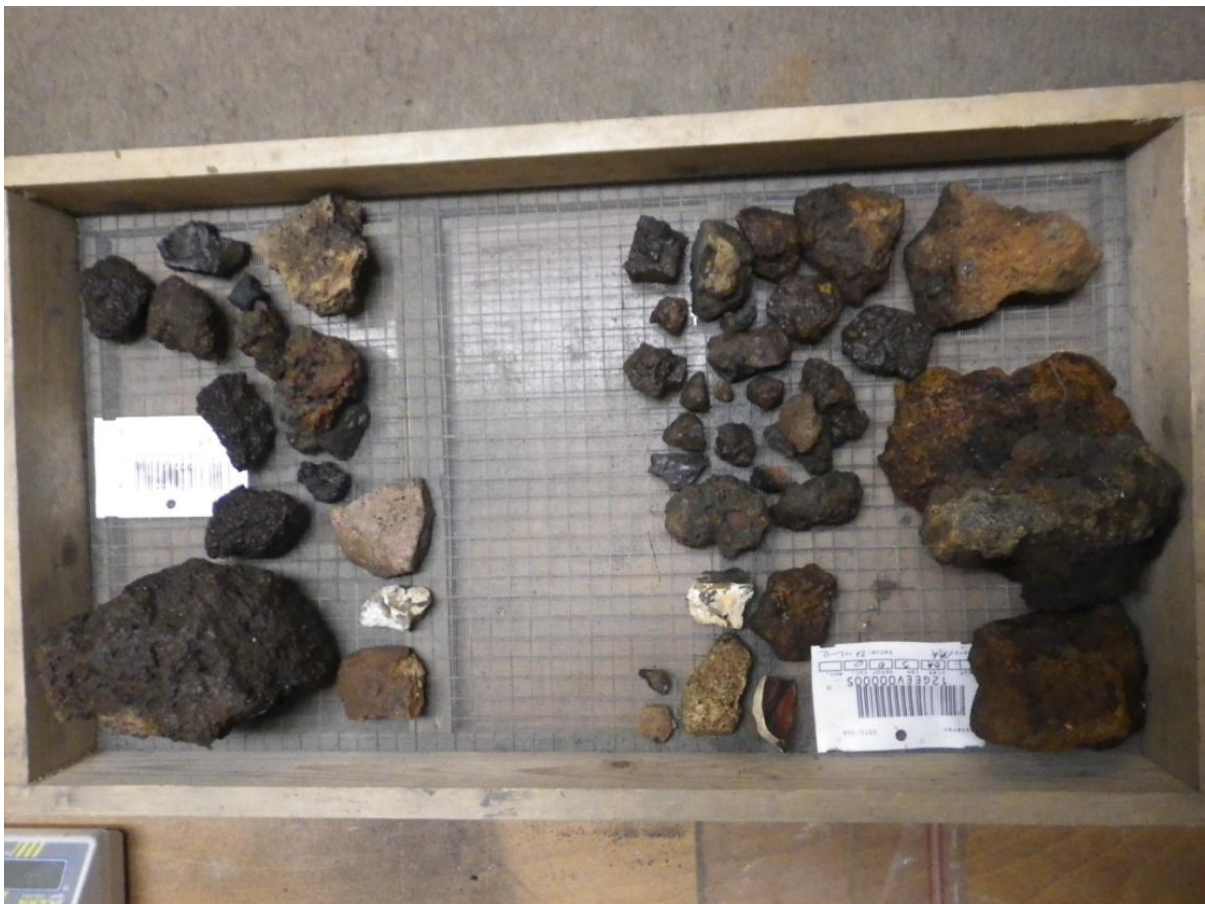
Afbeelding 44. Slakmateriaal en fragmenten van ovenmantels van ijzerproductie afkomstig uit de onderkant van het esdek aan de Velsweg (Veldhuis Weiden) in Geesteren. De restanten dateren uit de 11 de en 12 de eeuw en wijzen op een omvangrijke productie van ijzer uit moerasijzererts. Foto: Hamaland Advies Zelhem.
